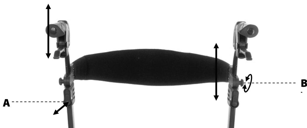
Povolte oba šrouby (B) proti směru hodinových ručiček a nastavte požadovanou výšku zádové opěrky. Zvolenou pozici zajistěte utažením šroubu po směru hodinových ručiček. Pro úplné odstranění opěrky zad šrouby zcela vyšroubujte a sundejte plastové objímky z eliptických trubek výsuvných madel.
